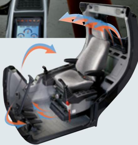
El aire acondicionado de alto rendimiento provee un caudal de aire que se ajusta y controla electrónicamente a las condiciones imperantes. Cinco modos de operación hacen que el operador más exigente pueda verse satisfecho.
