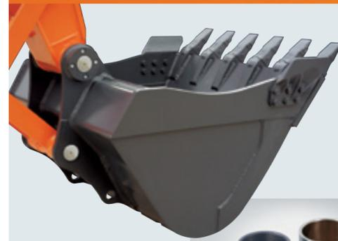
**Cuchara** Para los elementos más susceptibles tales como cuchillas, dientes, placas de refuerzo traseras y laterales y las esquinas de la cuchara se han utilizado materiales de alta resistencia al desgaste.
